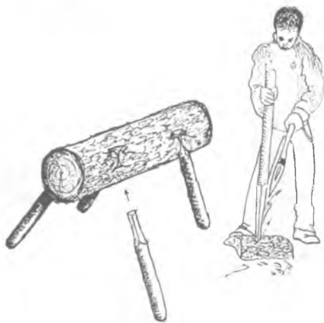
Spojování dřev „rybenkou“ – drží velmi pevně
